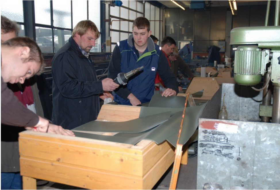
Bild 1: Die Teilnehmer bei praktischen Übungen; Hier die Verarbeitung von Teichfolien (Bild Klute)
